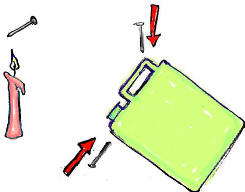
4. Chauffez le clou avec la bougie et faites deux trous dans le bidon
